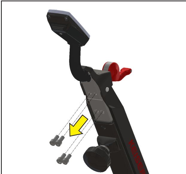
Abbildung 15: 8 mm Schrauben vom Lenkerrohr entfernen
