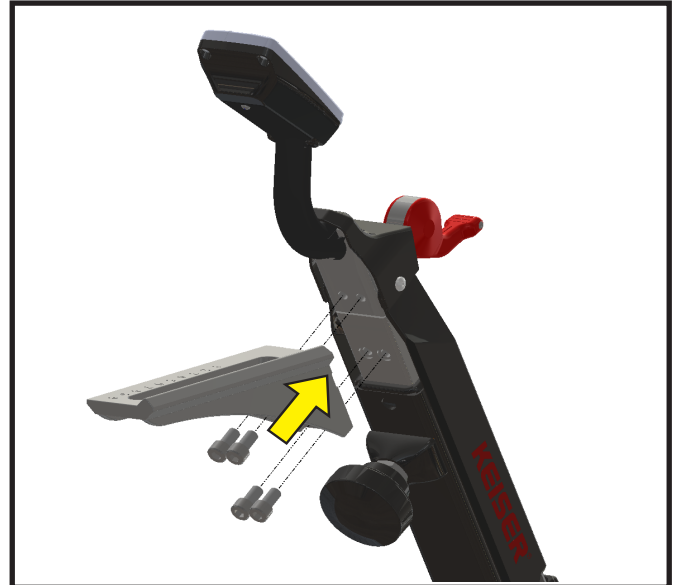
Abbildung 16: Befestigen der unteren Schiene am Lenkerrohr
